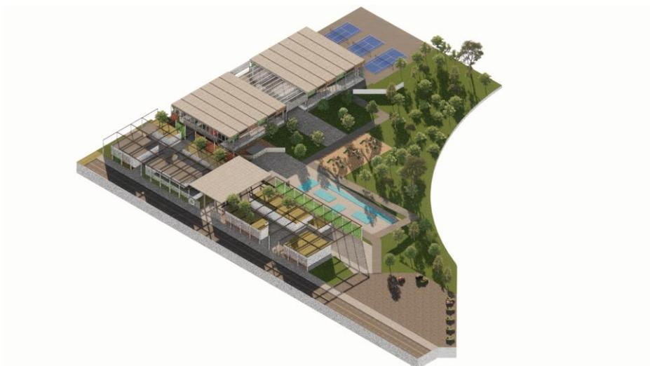
O uso de estrutura mista em concreto armado e metálica no Centro Raízes segue tendências apontadas por Engel (2001), que descreve a modularidade como estratégia de racionalização construtiva e flexibilidade espacial.
